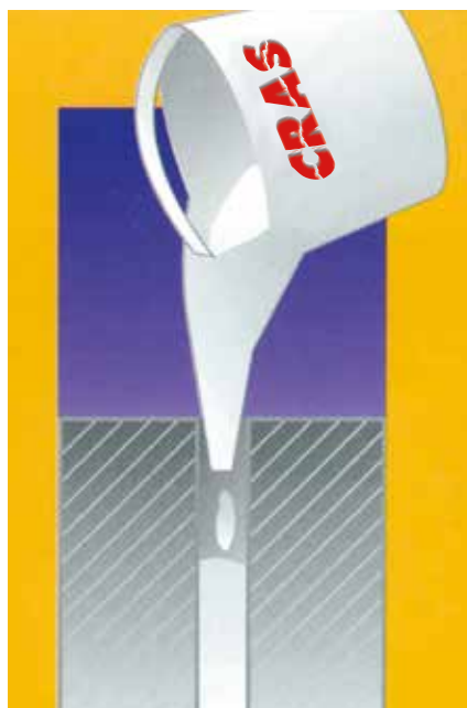
Fig 2. Sistema ideal para la correcta carga de agujeros horizontales.
